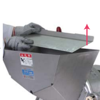
③滑り板を取り外す。
