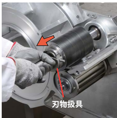
⑪刃物扱い具で丸刃・横切刃を外す
