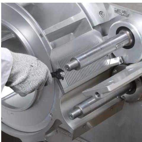
⑬平切り刃のナットを外して平切り刃を取り外す
