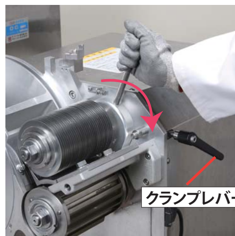
⑧クランプレバーを緩めて操作レバーを手前に倒す
