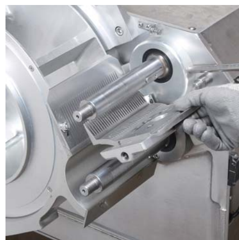
⑫スクレーパーのボルトを外してスクレーパーを取り外す
