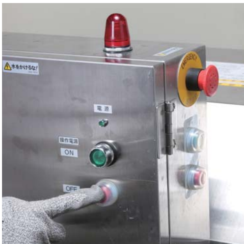
①電源・しゃ断器をOFFにする
