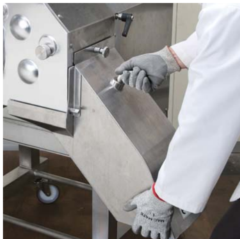
②シュートを取り外す
