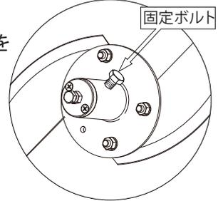
口金と刃面とのすき間調整は取扱説明書を参照して下さい。一度調整した刃物は使用するたびに調整する必要はありませんが、機械にセットしたときに接触するところがないか確認してください
